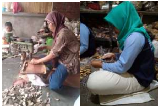
Gambar 1.2 Posisi Pekerja yang Tidak Ergonomis
