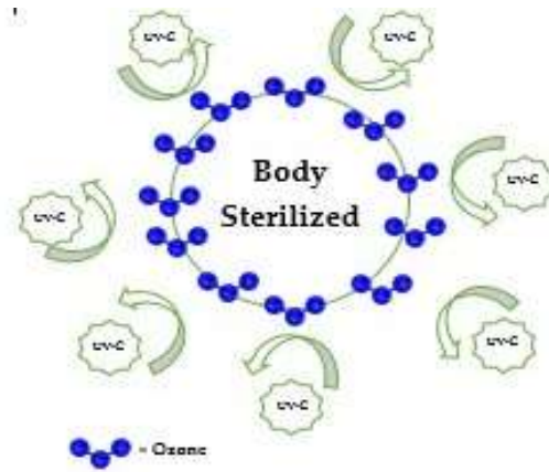
Gambar 2.2. UV-C light tidak bisa menembus permukaan yang telah terpapar ozon.
