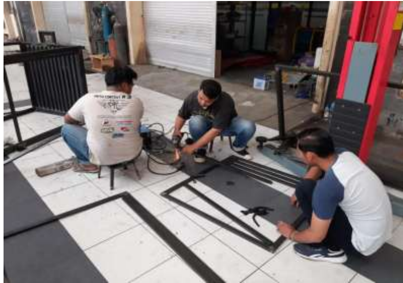
Gambar 3.9. Proses pemotongan besi sebagai rangka bilik
