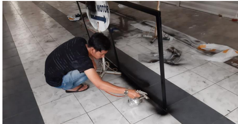
Gambar 3.10. Proses pengecatan rangka bilik
