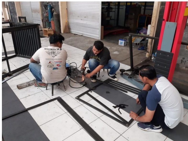
Gambar 3 9. Proses pemotongan besi sebagai rangka bilik
